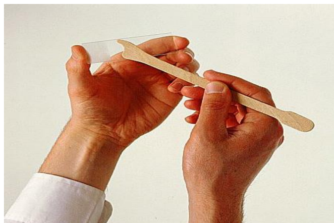
Фото 6. Наносят материал на предметное стекло
