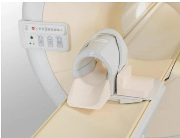
**Рис. 50.** Поверхностные катушки – специальные приемные антенны, предназначены для сбора радиочастотных сигналов от небольшой области тела непосредственно под катушкой. Их использование позволяет сканировать с более высоким разрешением определенные части тела, такие как голова или суставы
