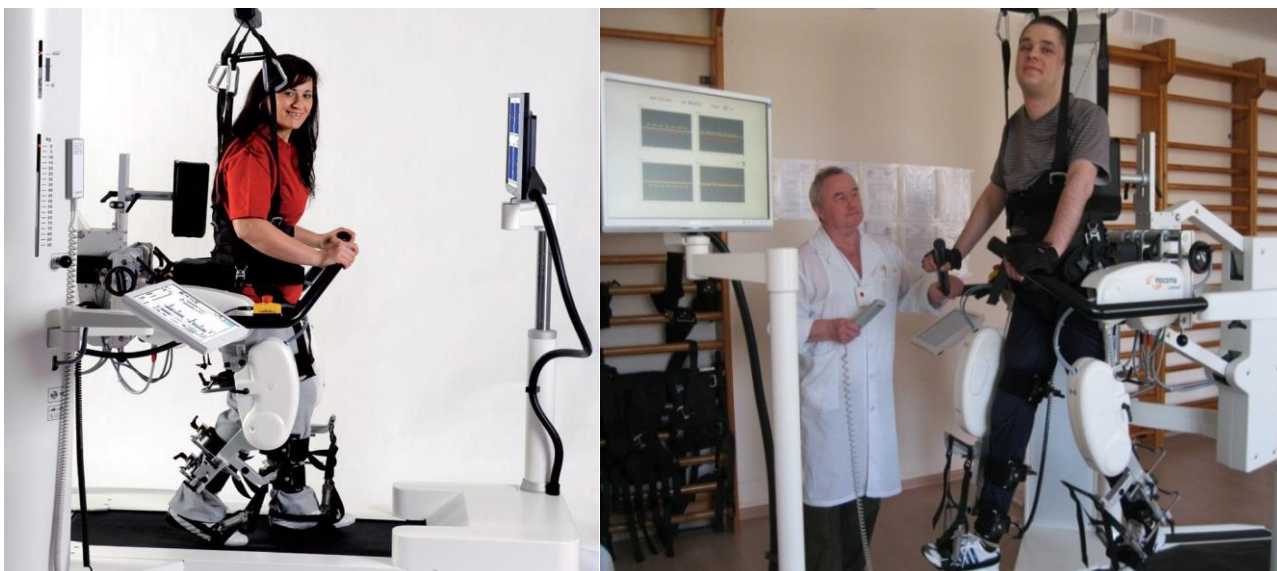
Рис. 4. Локомат («Носома», Швейцария) Реабилитационный комплекс с беговой дорожкой и роботизированным ортопедическим устройством для локомоторной терапии (Новикова Л.Б., 2014).
