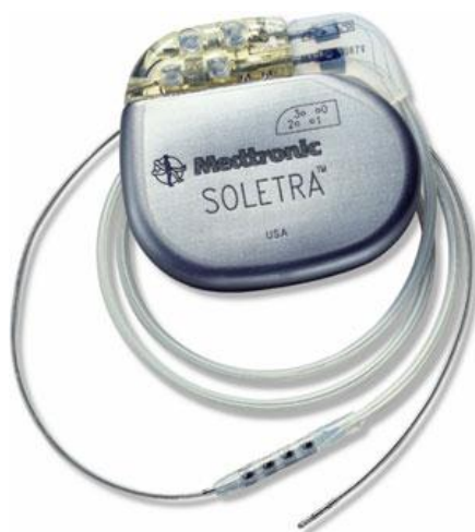
Рис. 16. Устройство для проведения глубокой стимуляции мозга.
